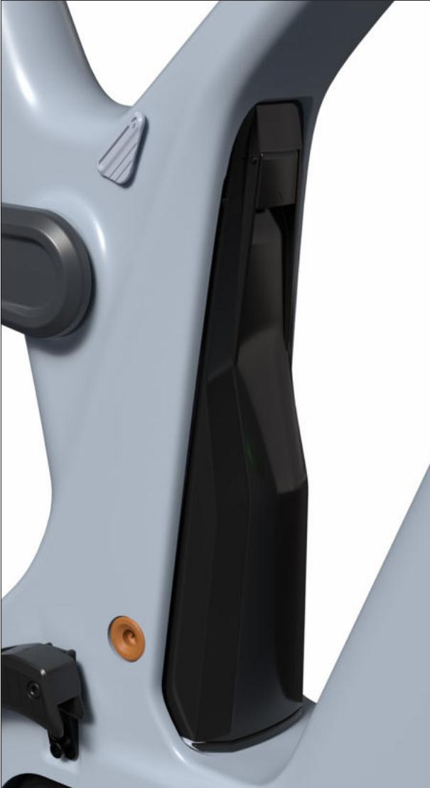
Die Dämpferabdeckung für den Scott Nude 6 Dämpfer wird oben mittels einer Lasche verriegelt und ist unten magnetisch für eine bessere Führung. Diese Abdeckung deckt den Dämpfer komplett ab.
