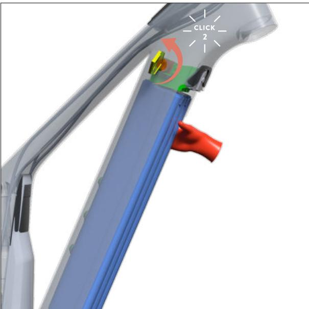
**03** Lassen Sie den Schlüssel los, und drücken Sie ein weiteres Mal auf die Batterie. Daraufhin hören Sie ein zweites Klicken. Danach ist die Batterie sicher eingerastet.
