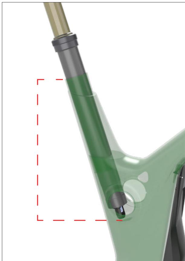
Im Inneren des Sitzrohrs befindet sich ein Anschlag um Beschädigungen des Rahmens zu vermeiden.
