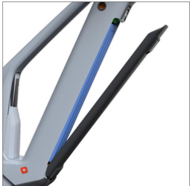
**04** Setzen Sie den unteren Teil der Batterieabdeckung in den Rahmenausschnitt wie auf dem Bild gezeigt.
