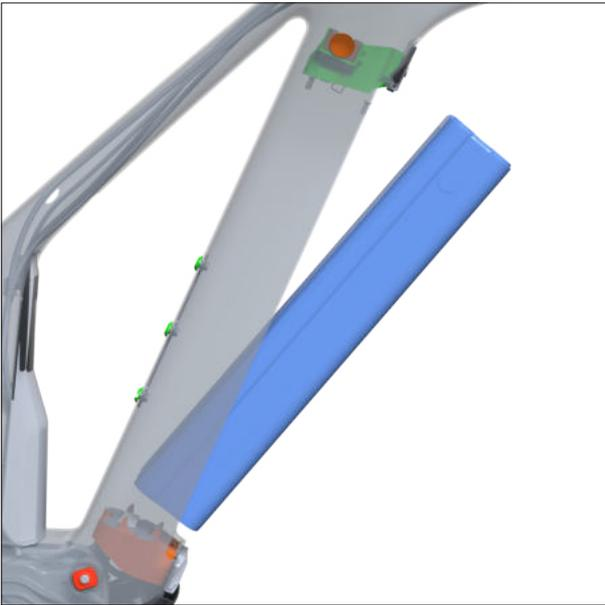
**01** Setzen Sie die Batterie mit dem unteren Ende zuerst ein.
