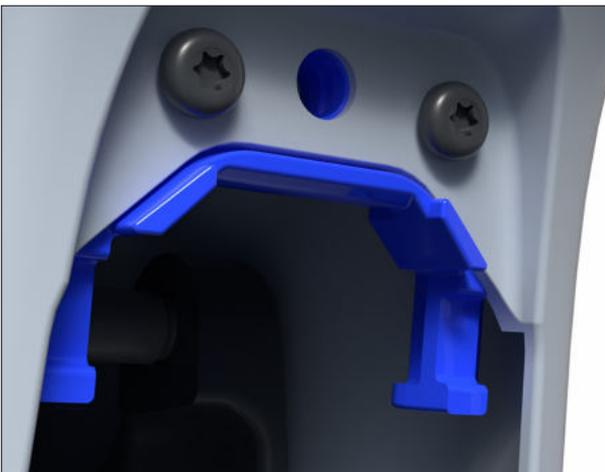
Beide Stoßdämpferabdeckungen verwenden die gleiche Stoßdämpferabdeckungshalterung. Dies dient auch als Kabelführung für alle Kabel abgesehen von Bosch Kabeln.
